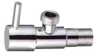
22,60€ Válvula escuadra doble Arco A80 1/2x3/8x3/8". Vitaq System. PN16. Sin tuerca. Acabado cromo. Sistemas de apertura y cierre 1/4 de vuelta. 831F4
